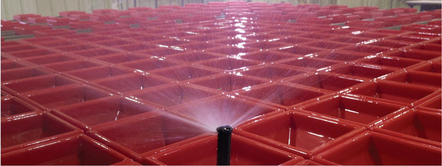
Las pruebas de laboratorio y las pruebas de campo independientes de terceros demuestran una eficiencia de entre un 15% y un 20% más alta que las boquillas competidoras a una distancia de 4.6 m (15') o menos.
