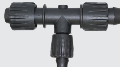
TL-T-HDR La te con reductor de Tri-Loc conecta manguera de goteo de 16 mm, 17 mm y 18 mm (0.63", 0.67" y 0.71") DE a la manguera Toro® T-EHD2057 con DI de 0.805 (20 mm). El acoplamiento TL-T-HDR también funciona con manguera de 0.790" – 0.845" DI (20 mm – 21.5 mm)
